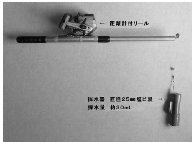
図3 簡易層別採水器
