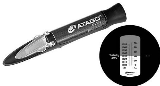
図2 海水濃度屈折計 右図は接眼鏡内の目盛
